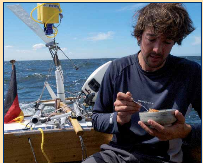
Selbstgebaute Windsteueranlage in Aktion, montiert auf zwei Abwasserrohren aus PVC
