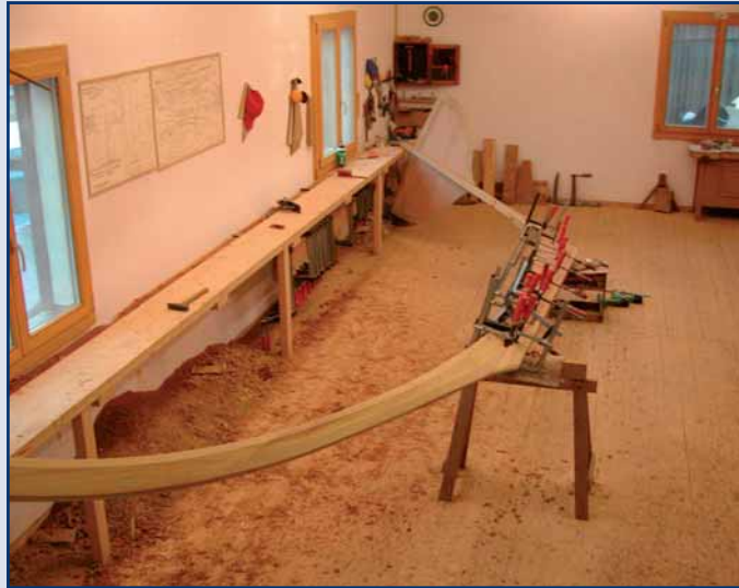
Vorsteven, Kielsohle, Achterstegen und Heckspiegel sind zusammengefügt
