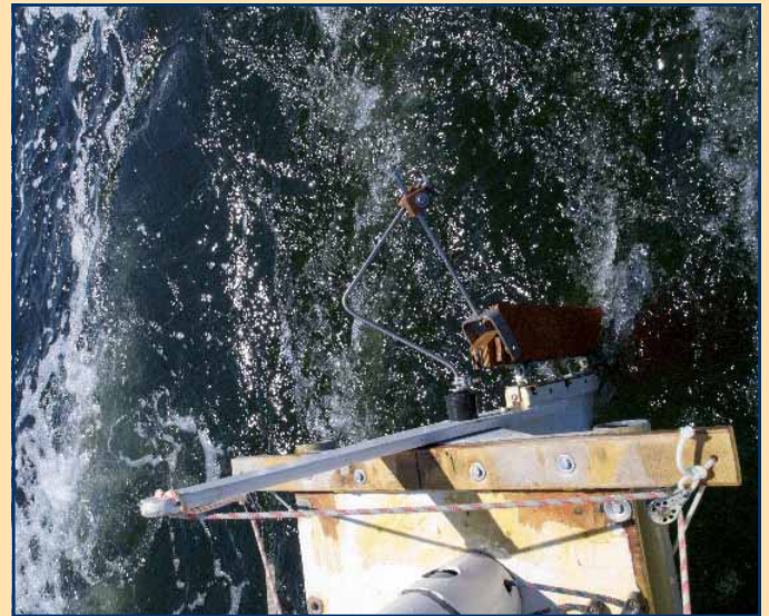
Servopendelruder der WSA. Etwas Sperrholz, Abwasserrohre, Gewindestangen - viel mehr braucht es nicht
