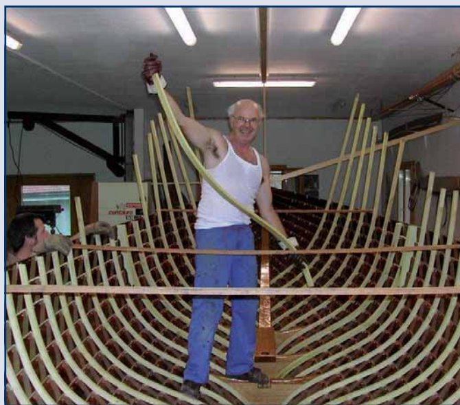
Einbiegen der Spanten
