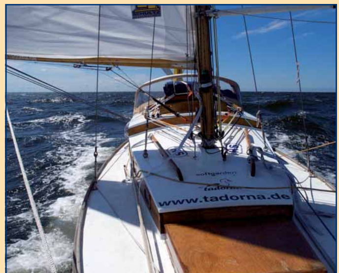
Vor dem Wind, mit Bullentalje und ausgebaumter Fock, Bucht von Riga. Maximalgeschwindigkeit an diesem Tag 12,9 Knoten, die Welle runter
